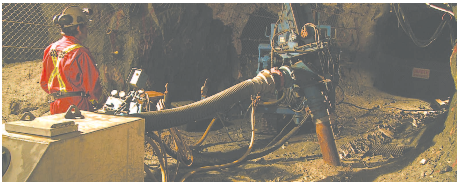
Rocmec utilise la méthode de fragmentation thermique pour faire éclater la roche minéralisée en or.
